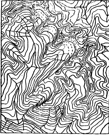
Горизонтали разреженной шкалы принятая для обобщенного рисунка утолщены м. 1:50 000
