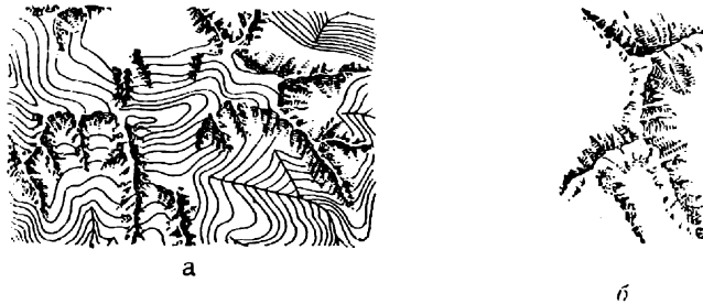
Рис. 20. Изображение скал на карте масштаба 1:1 000 000: а — первого издания; б — второго издания.
