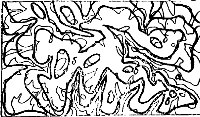
Рис. 87. Увеличение всех элементов рельефа при обобщении; а — преувеличенные долины; б — преувеличенные вершины; в — объединенные вершины с преувеличением их площади.
