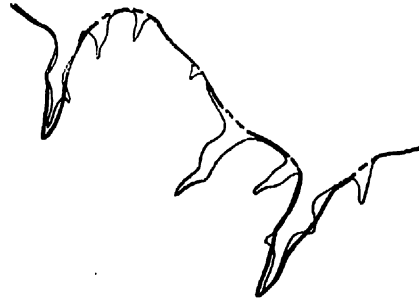
Рис. 86. Спрявление горизонталей на месте исключенных деталей.
