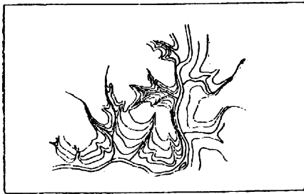
Рис. 33. Отражение горизонталями крутизны и характера склонов.
