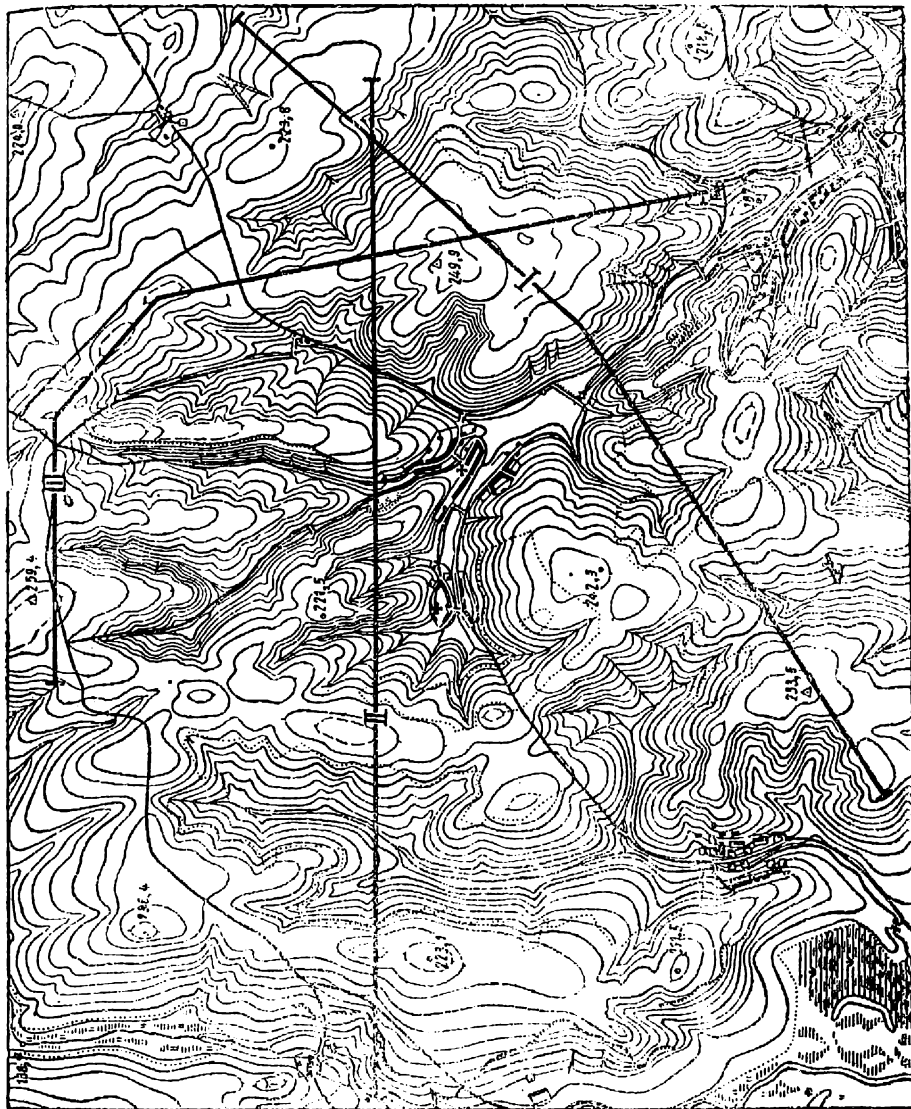
Рис. 17. Ключевок участок для выбора шкалы сечения I, II, III — линии профилей.
