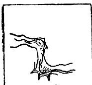
Рис. 28. Отражение горизонталями поперечного профиля долины.
