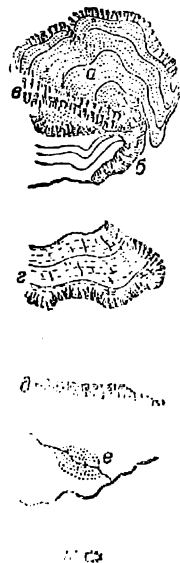
Рис. 21. Условные знаки льдов, масштаба 1 : 1 000 000: а — фирновый покров; б — ледник; в — скалы, покрытые вечным снегом и льдом; г — ледниковые трещины; д — ледяные обрывы; е — наледи на реках; ж — булгуньями.
